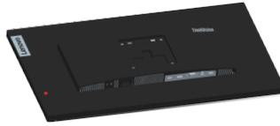
Schritt 4: Bringen Sie die Halterung aus dem VESA-Wandmontageset (100 × 100 mm Lochabstand) mit M4 x 10 mm-VESA-Montageschrauben an.
