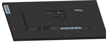
Schritt 4: Bringen Sie die Halterung aus dem VESA-Wandmontageset (100 × 100 mm Lochabstand) mit M4 x 10 mm-VESA-Montageschrauben an.
